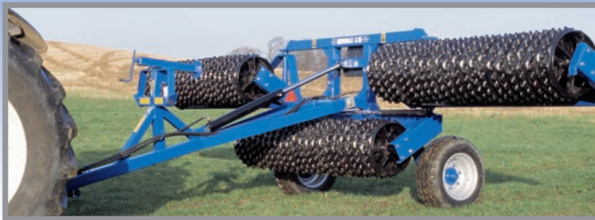
Udfoldning af tromlens sidesektioner styres af en dobbeltvirkende cylinder.
