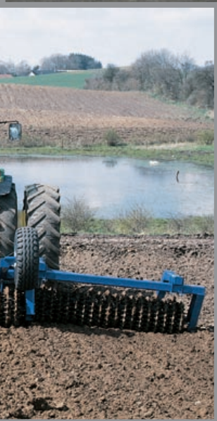
DUOFLEX -Systemet med akkumulatorer muliggør, at hver tromlesektion frit kan følge jordoverfladen.
